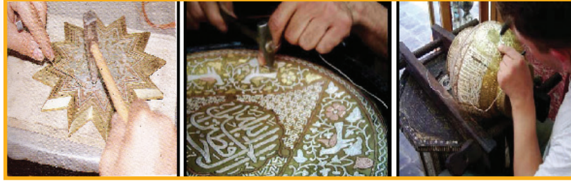
الشكل (٨١): طريقة التكفيت
